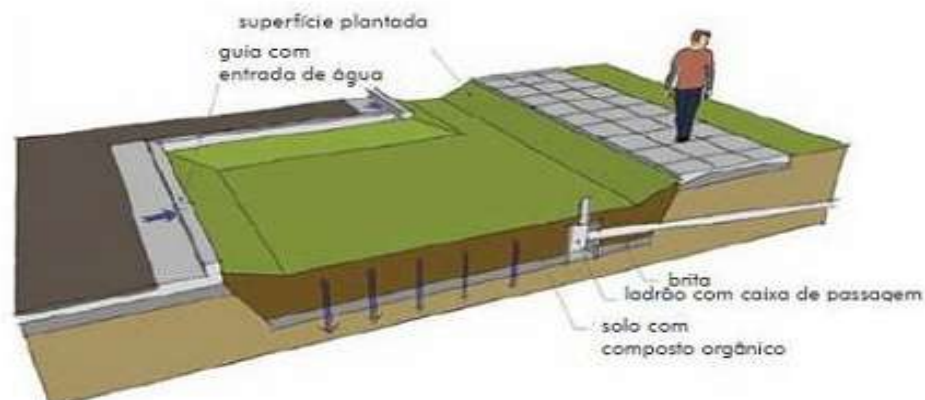
Figura 61: Esquema de um jardim de chuva
