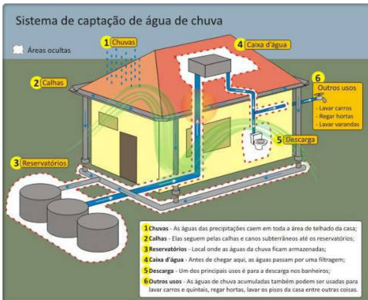
Figura 29: Sistema de captação de água de chuva
