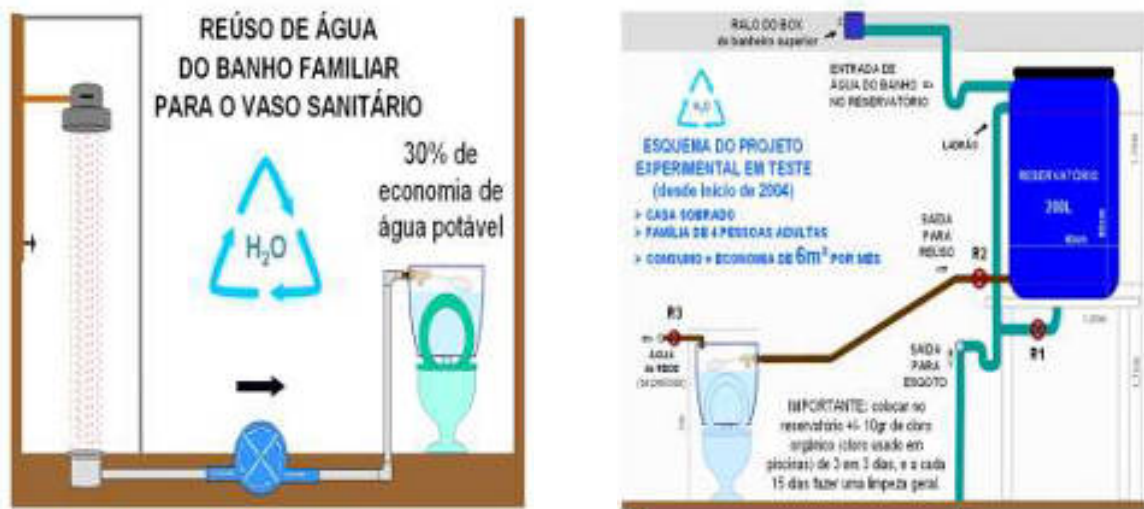
Figura 36: Esquemas simplificados de reuso de efluentes
