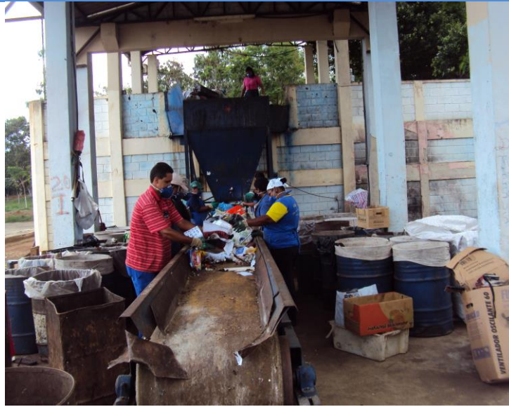
Figura 12: UTC de Prudente de Morais – Esteira de triagem Fonte: Prefeitura Prudente de Morais, 2015.
